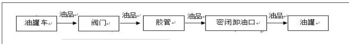
图 2.5-4 柴油卸油工艺流程图
