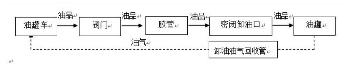
图 2.5-3 汽油卸油工艺流程图
