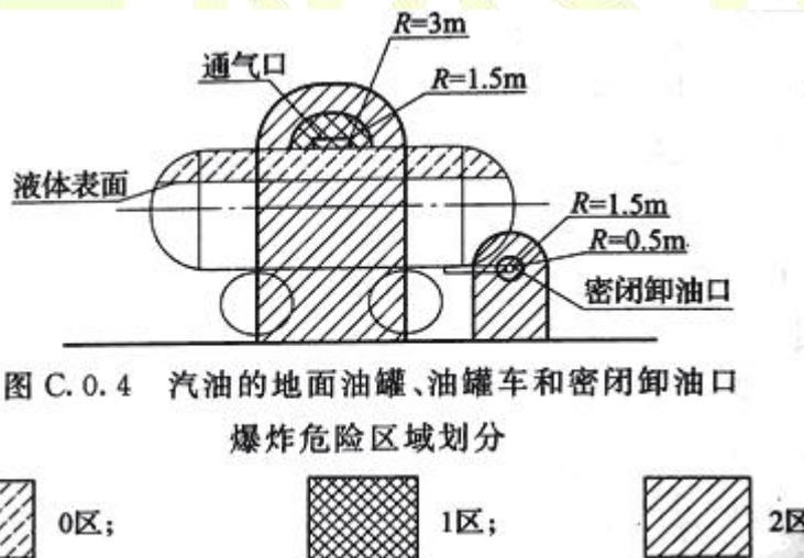
图 3.10-3 油罐车卸汽油爆炸危险区域
