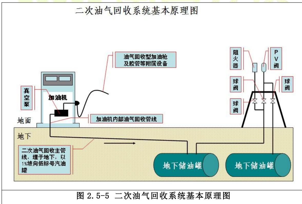
图 2.5-5 二次油气回收系统基本原理图
